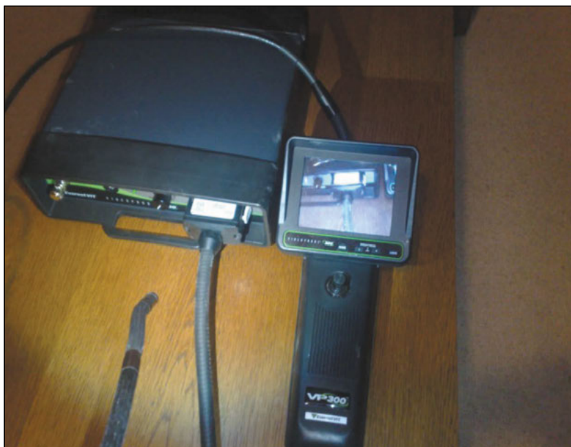
Fot. 2. Endoskop określany również mianem kamery inspekcyjnej, (fot. K. Krajewski).
