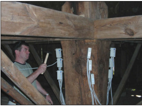
Fot. 8. Badanie drewna za pomocą tomografu impulsowego Arbotom, (fot. K. Krajewski): a) wzbudzenie impulsów w głowicach nadawczych tomografu impulsowego na przykładzie obiektu z Muzeum Rolnictwa w Ciechanowcu, b) wizualizacja komputerowa wyników badań tomografem impulsowym drewna pochodzącego z rozebranego obiektu zagrodowego.
